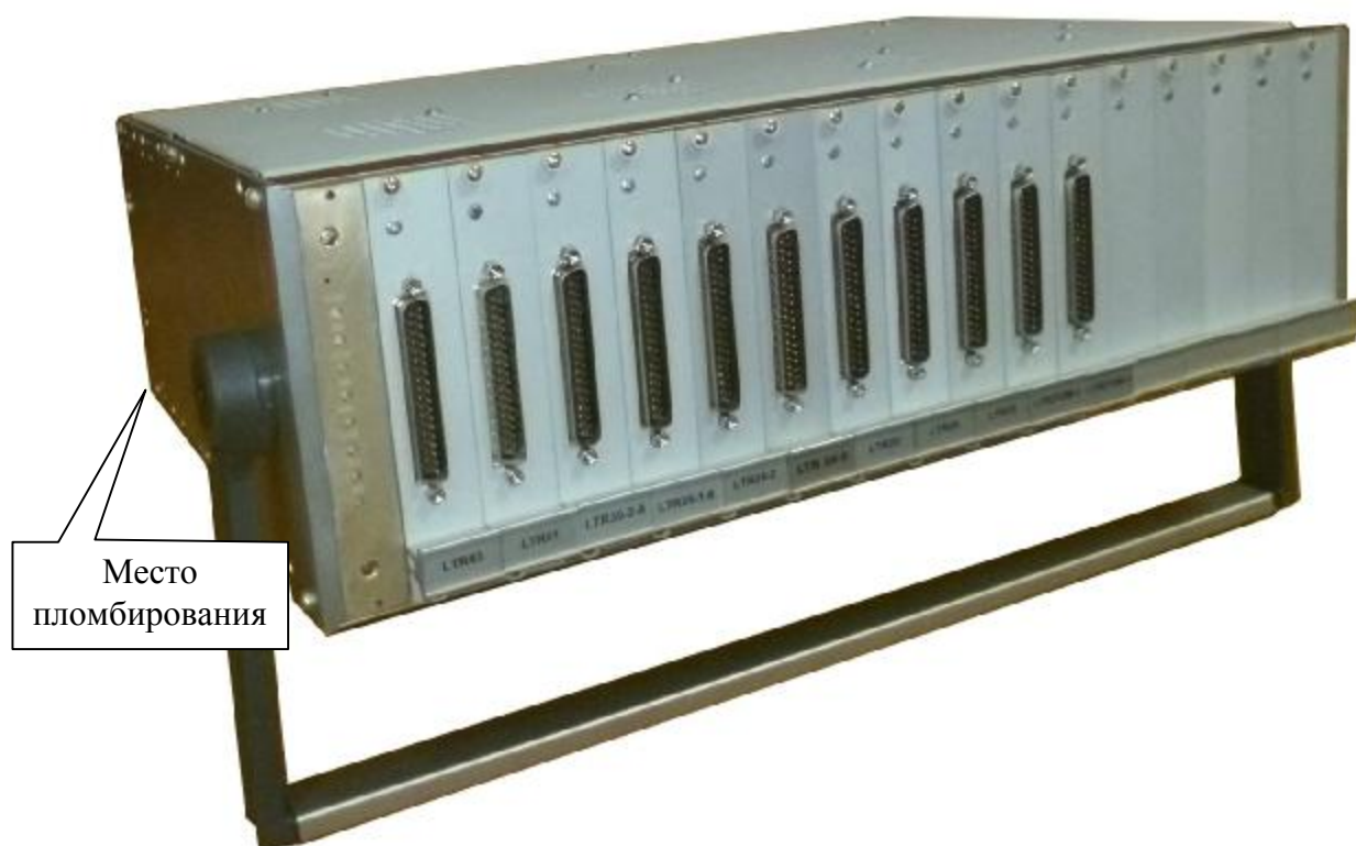
Рисунок 7 – Общий вид установок LTR-AEU-16 и место пломбирования от несанкционированного доступа
