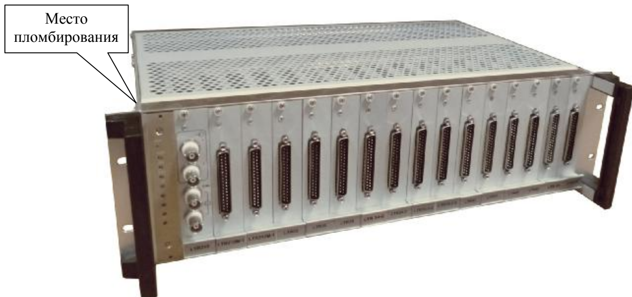
Рисунок 8 – Общий вид установок LTR-DEU-16 и место пломбирования от несанкционированного доступа
