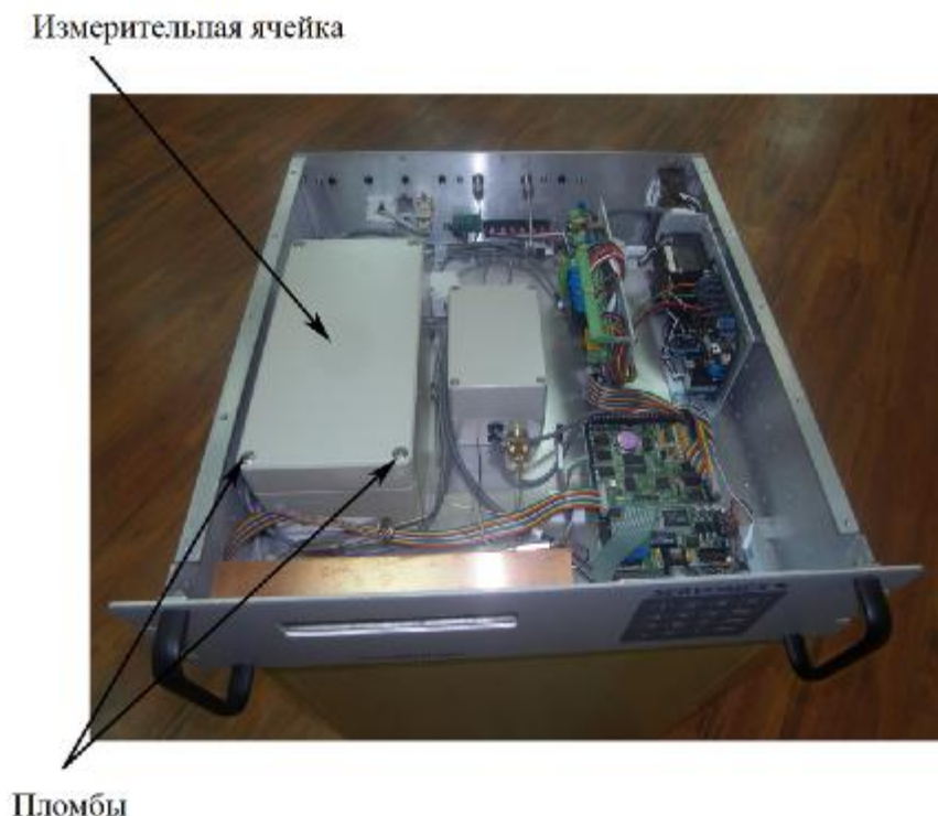
Рисунок 2 – Место пломбирования измерительной ячейки
