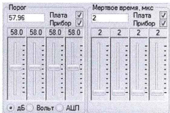
Рисунок 5 - Панели «Порог» и «Мертвое время» на панели «Платы»
