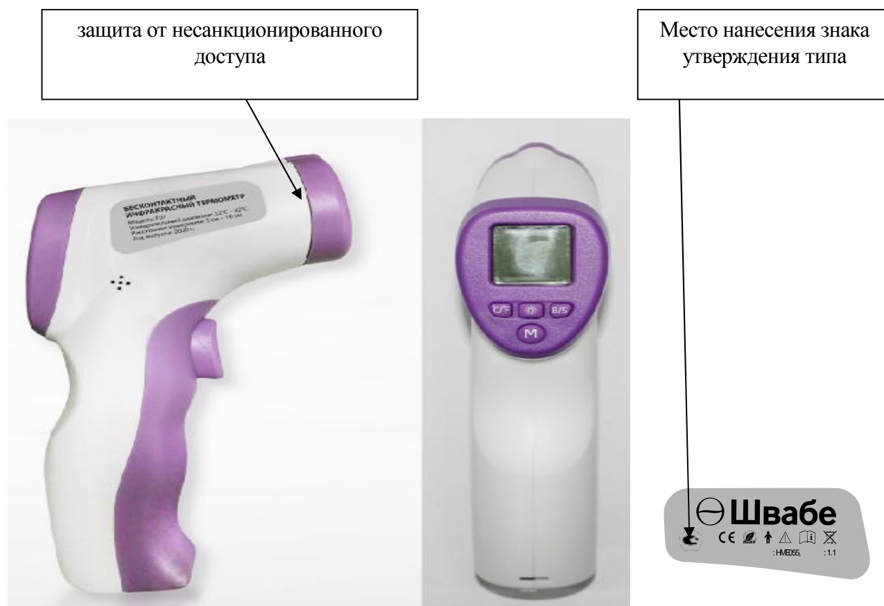
Рисунок 1 - Общий вид и схема защиты от несанкционированного доступа термометров бесконтактных инфракрасных, модель F01
