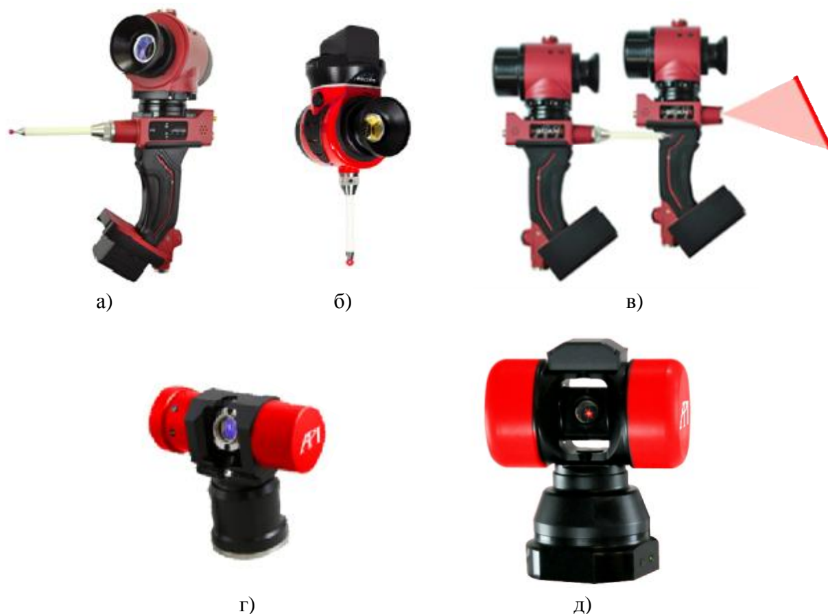
Рисунок 2 – Общий вид дополнительных устройств (а – щуп iProbe; б – щуп vProbe; в – комбинированное устройство iScanII/iScanIII; г – активный отражатель Active Target, д – шестикоординатное устройство SmartTrack)
