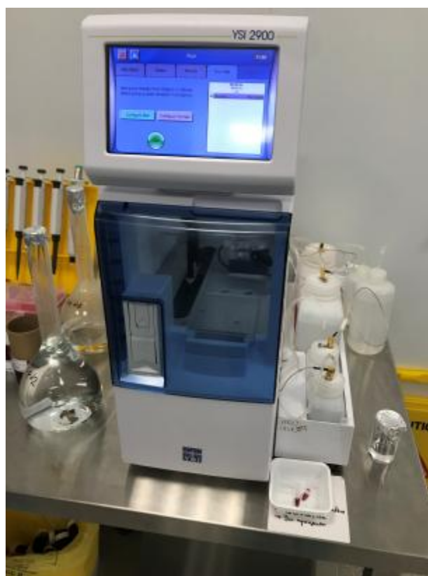
Рисунок 1 - Общий вид анализатора глюкозы YSI 2900
