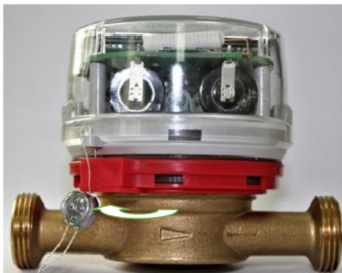
Рисунок 2 – Схема пломбировки от несанкционированного доступа, обозначение места нанесения знака поверки счетчиков холодной и горячей воды крыльчатых МИРТЕК-71-РУ
