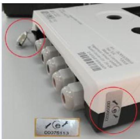
Рисунок 3 – Схема пломбировки от несанкционированного доступа эксплуатирующей организацией
