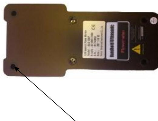
Рисунок 6 - Место пломбирования электронного блока SLS-720P
