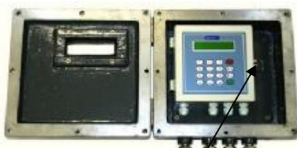
Рисунок 9 - Место пломбирования электронного блока SLS-720E
