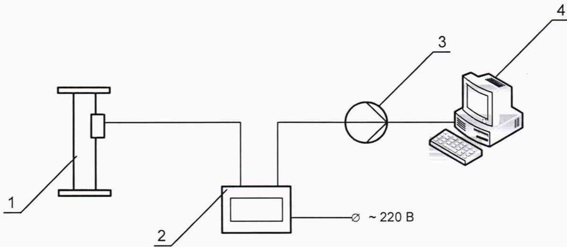
Рис. А1. Схема подключения электрических соединений влагомера АМ-ВОЕСН при поверке в лаборатории
