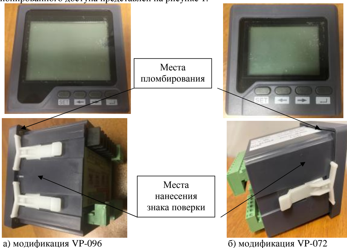
Рисунок 1 - Общий вид приборов с указанием мест нанесения знака поверки и пломбирования от несанкционированного доступа
