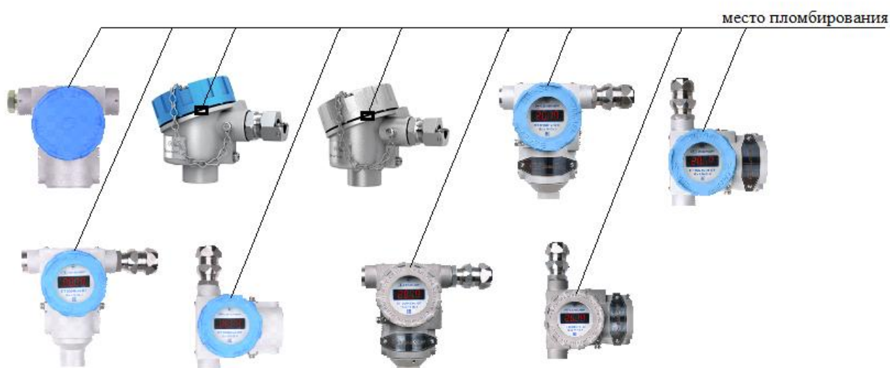
Рисунок 7 – Схема пломбировки от несанкционированного доступа
