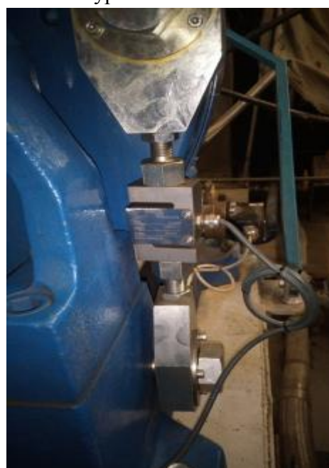
Рисунок 14 – Тензометрический датчик U4000 в составе динамометра Фруд-Хофманн AG-250HS
