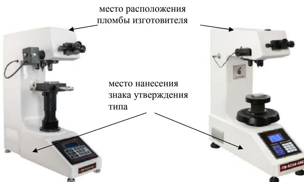
Рисунок 3 – Общий вид твердомеров ТВ 5214-5С Tochline
