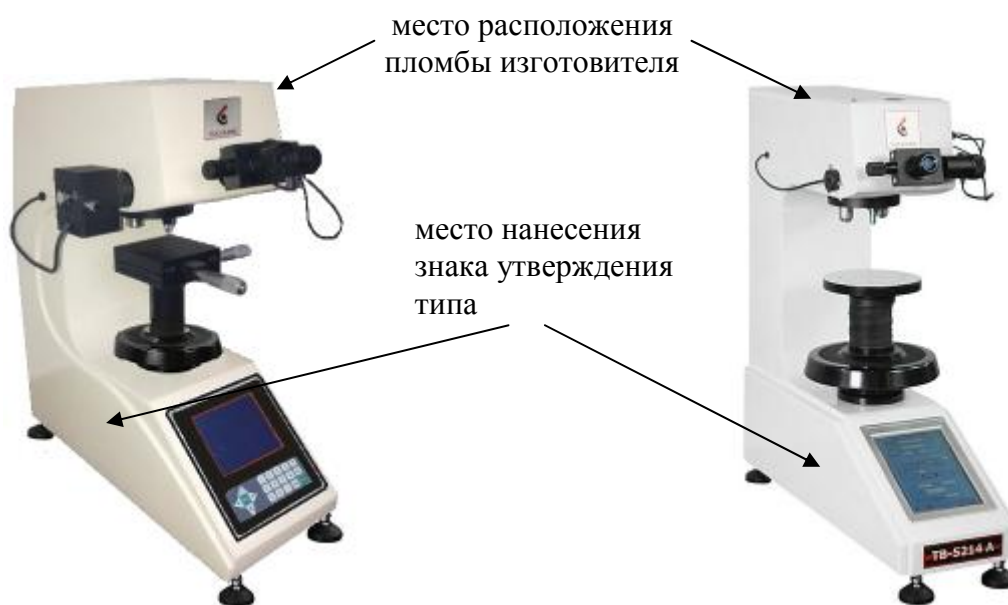
Рисунок 1 – Общий вид твердомеров ТВ 5214-5 Tochline, ТВ 5214-10 Tochline, ТВ 5214-30 Tochline, ТВ 5214-50 Tochline, ТВ 5214-100 Tochline
