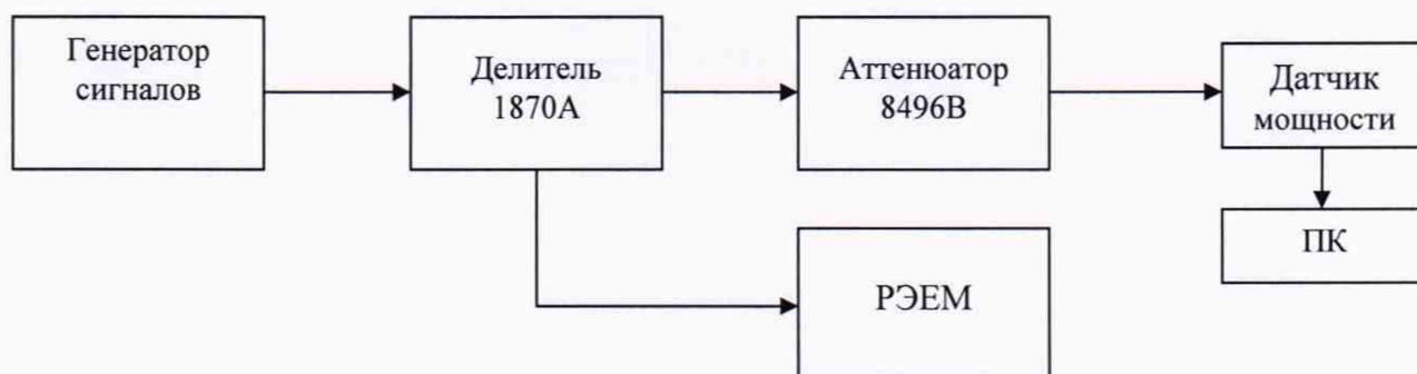
Рисунок 4 – Схема определения составляющей относительной погрешности измерения мощности, зависящей от уровня мощности
