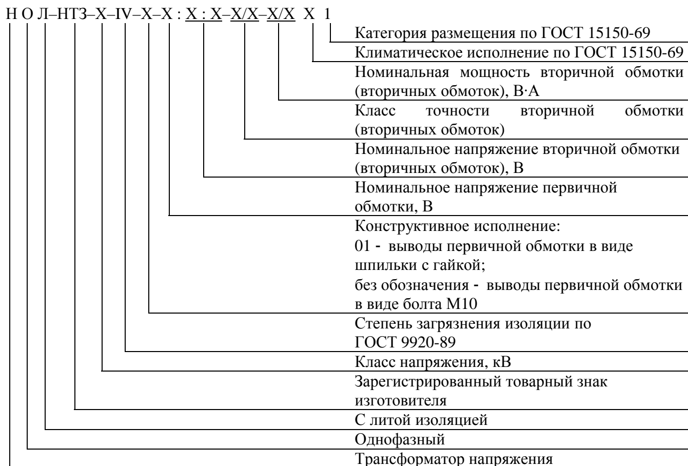
Рисунок 1 – Структура условного обозначения трансформаторов напряжения наружной установки НОЛ-НТЗ-IV
