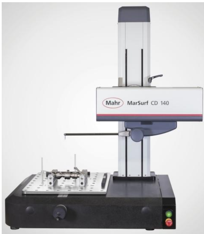
Рисунок 1 – Общий вид приборов для измерений параметров контура поверхности MarSurf CD 140 и MarSurf CD 280
