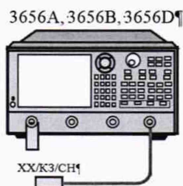
Рисунок 5 - Схема полной двухпортовой калибровки
