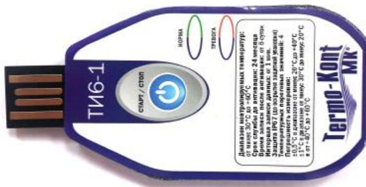
Рисунок 1 – Общий вид термоиндикаторов
