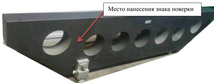
Рисунок 2 – Схема обозначения места для нанесения знака поверки.
