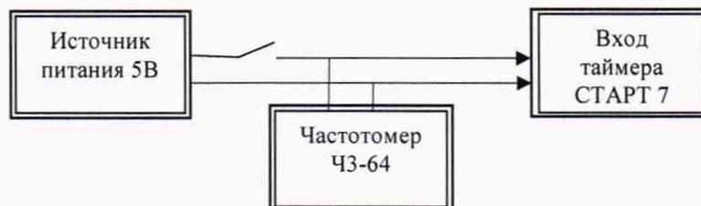
Рисунок 1 – Схема подключения
