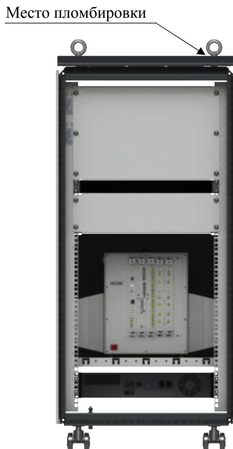
Рисунок 2 – Схема пломбировки от несанкционированного доступа системы автоматизированной измерительной ПКИПО
