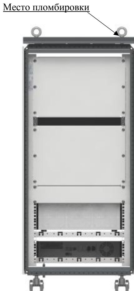
Рисунок 2 – Схема пломбировки от несанкционированного доступа системы автоматизированной измерительной БУ
