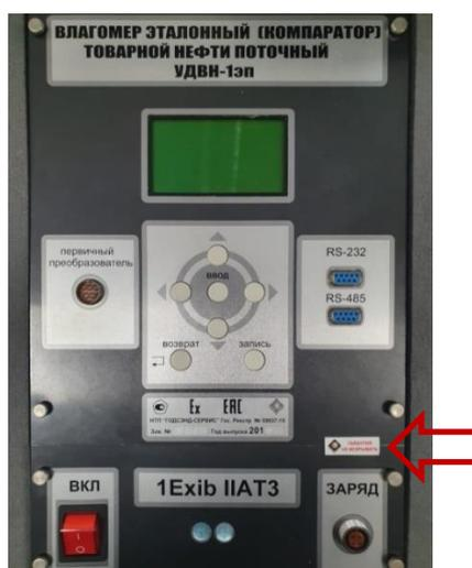
Рисунок 2 – Место пломбирования влагомера
