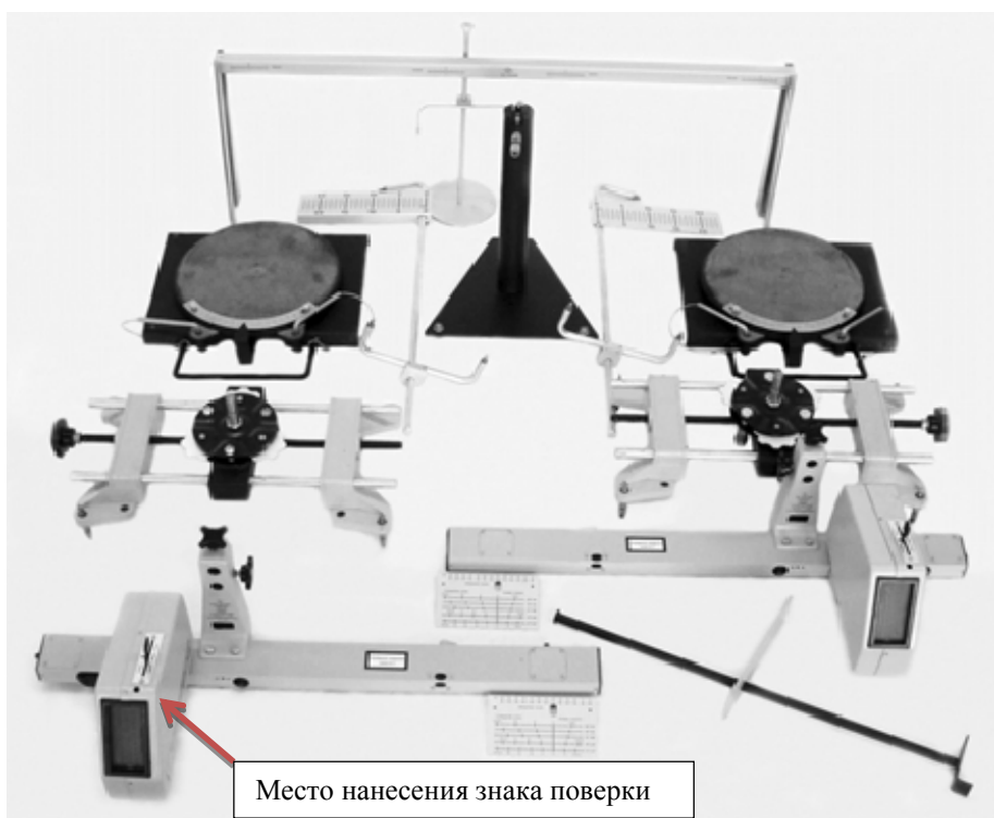
Рисунок 1 – Общий вид стендов для измерения, регулировки и контроля углов установки колес автомобилей «Тест-система лазерная СКО-1Л»
