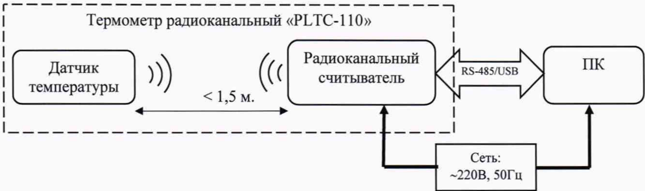
Рисунок Б2. Схема определения абсолютной погрешности
