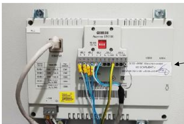
Рисунок 3 – Место нанесения разрушающейся наклейки на контроллере
