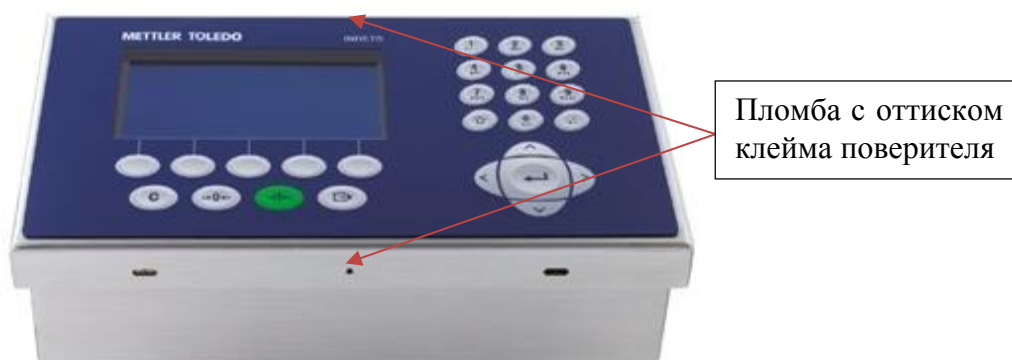
Рисунок 3 – Схема пломбирования от несанкционированного доступа, место нанесения знака поверки
