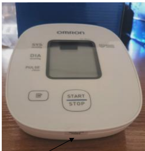
Рисунок 3 - Место нанесения защитной наклейки от несанкционированного доступа
