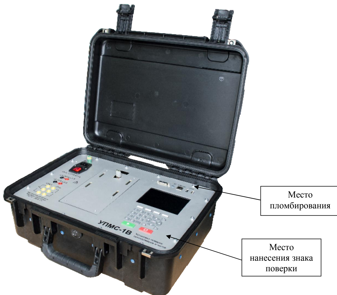
Рисунок 1 – Общий вид установок с указанием места нанесения знака поверки и места пломбирования от несанкционированного доступа
