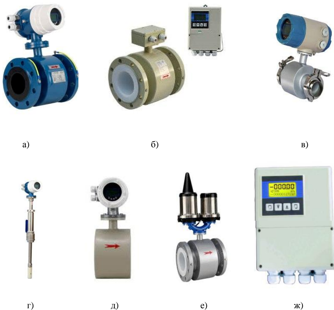
Рисунок 1 – Расходомеры электромагнитные MGG (интеллектуальные): а) MGG/IF – фланцевый интегральный, б) MGG/CF – фланцевый раздельный, в) MGG/IS – санитарный, г) MGG/ID – вставной интегральный, д) MGG/IO – обжимной интегральный, е) MGG/CFA – фланцевый с автономным питанием, ж) электронный преобразователь для раздельного исполнения
