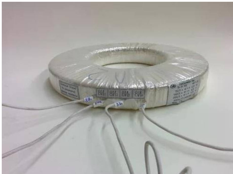
Рисунок 1 – Общий вид трансформаторов
