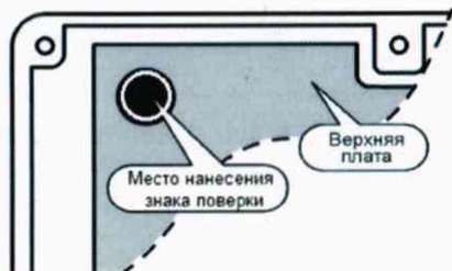
Рис. Д.4 Место нанесения знака поверки - на крепежный винт защитного каркаса электронного модуля (р.10.4 РЭ)
