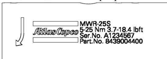
Рисунок 8 - Общий вид типовой маркировки ключей серий MWR-S
