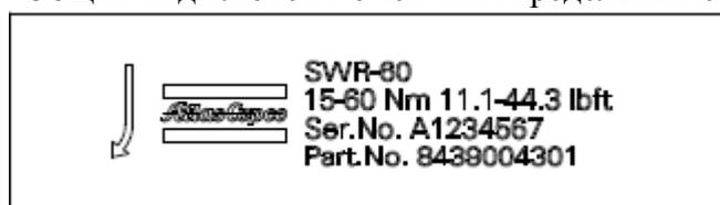
Рисунок 5 - Общий вид типовой маркировки ключей серий SWR
