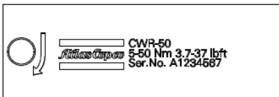
Рисунок 6 - Общий вид типовой маркировки ключей серий CWR
