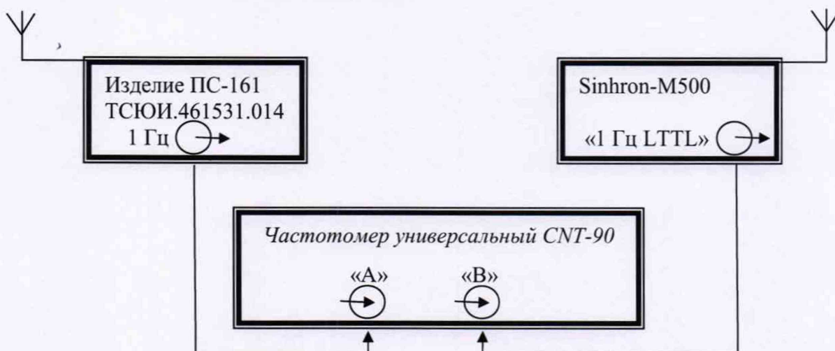
Рисунок 2 – Схема для определения абсолютной разности формируемой ШВ относительно национальной шкалы координированного времени UTC(SU) в режиме синхронизации по сигналам ГНСС ГЛОНАСС/GPS
