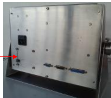
Рисунок 4 — Общий вид и схема пломбировки прибора весоизмерительного ЭТД-01 (пример)
