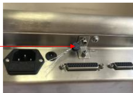
Рисунок 3 — Общий вид и схема пломбировки прибора весоизмерительного ЭТА-01 (пример)
