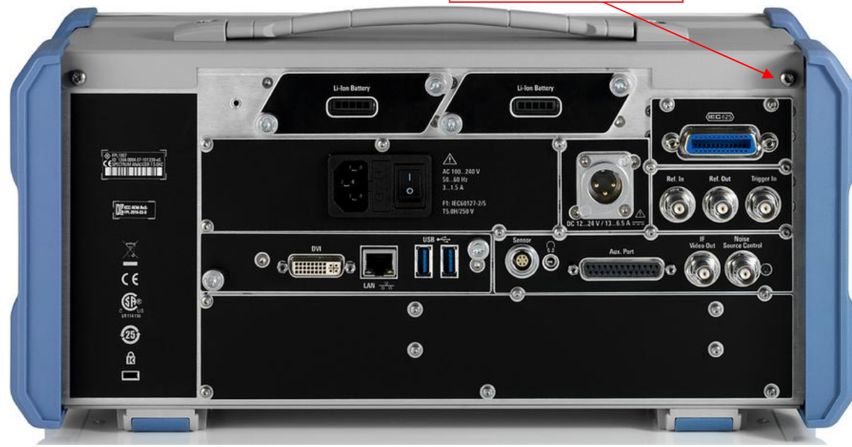
Рисунок 2 - Схема пломбировки анализаторов спектра FPL1003, FPL1007 от несанкционированного доступа
