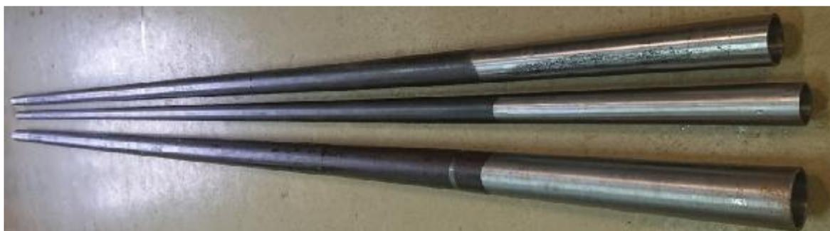
Рисунок 1 – Общий вид мер с искусственными дефектами 452.008
