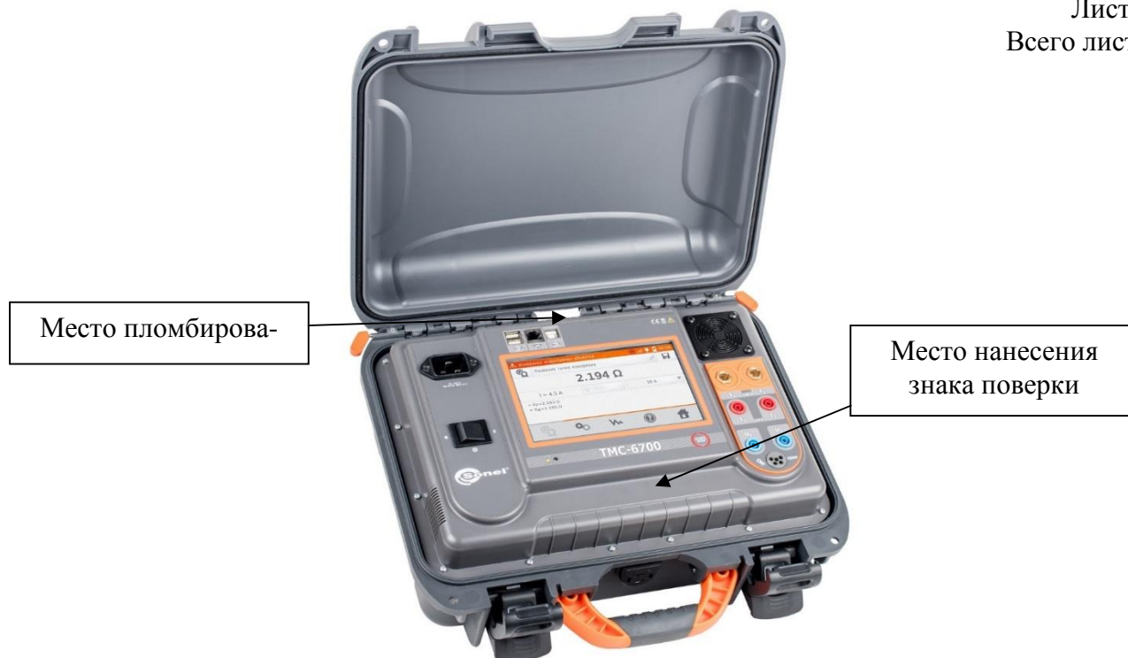
Рисунок 3 – Общий вид микроомметров модификации ТМС-6700, место нанесения знака поверки и место пломбирования
