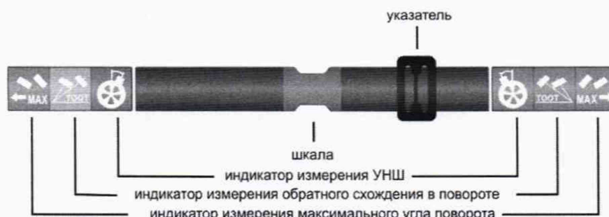
Рисунок Б.9 – Диаграмма измерений углов продольного и поперечного наклона оси поворота колес
