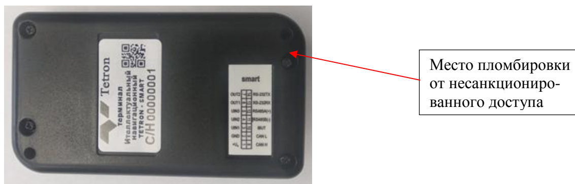
Рисунок 4 - Место пломбировки от несанкционированного доступа терминалов интеллектуальных навигационных (аппаратуры) Tetron-Smart
