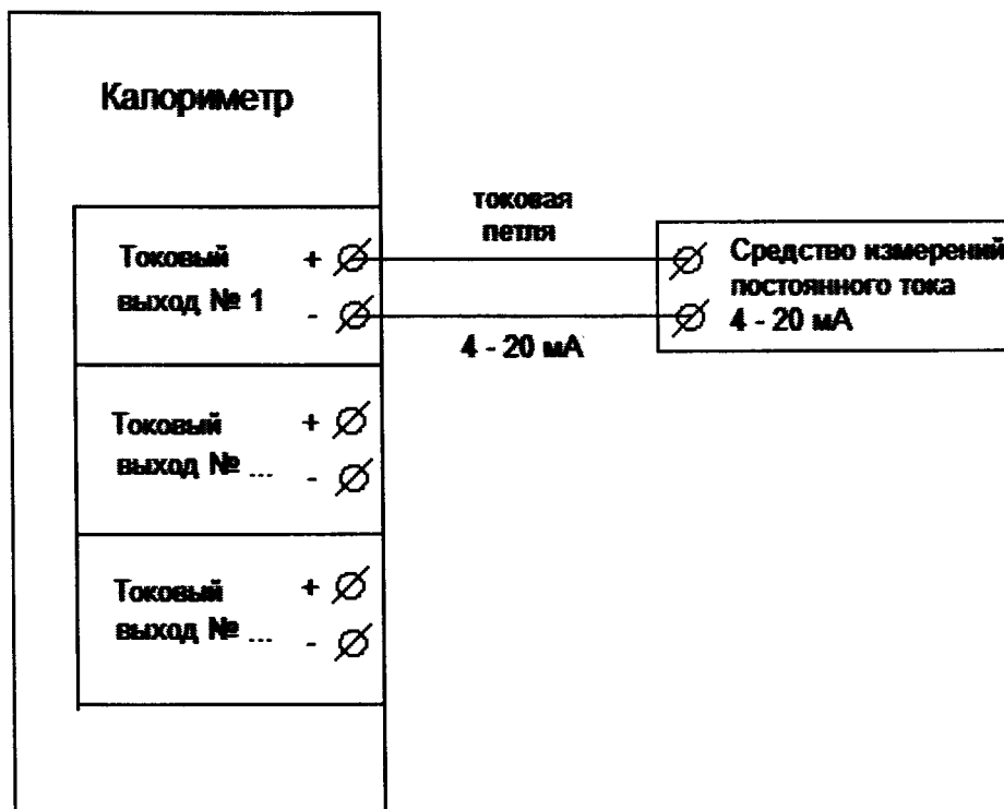
Рисунок А.1 – Пример подключения средств поверки для определения метрологических характеристик калориметра по токовому выходу
