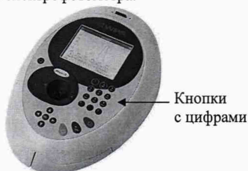
Рисунок 4 – Расположение кнопок с цифрами на корпусе спектрофотометра
