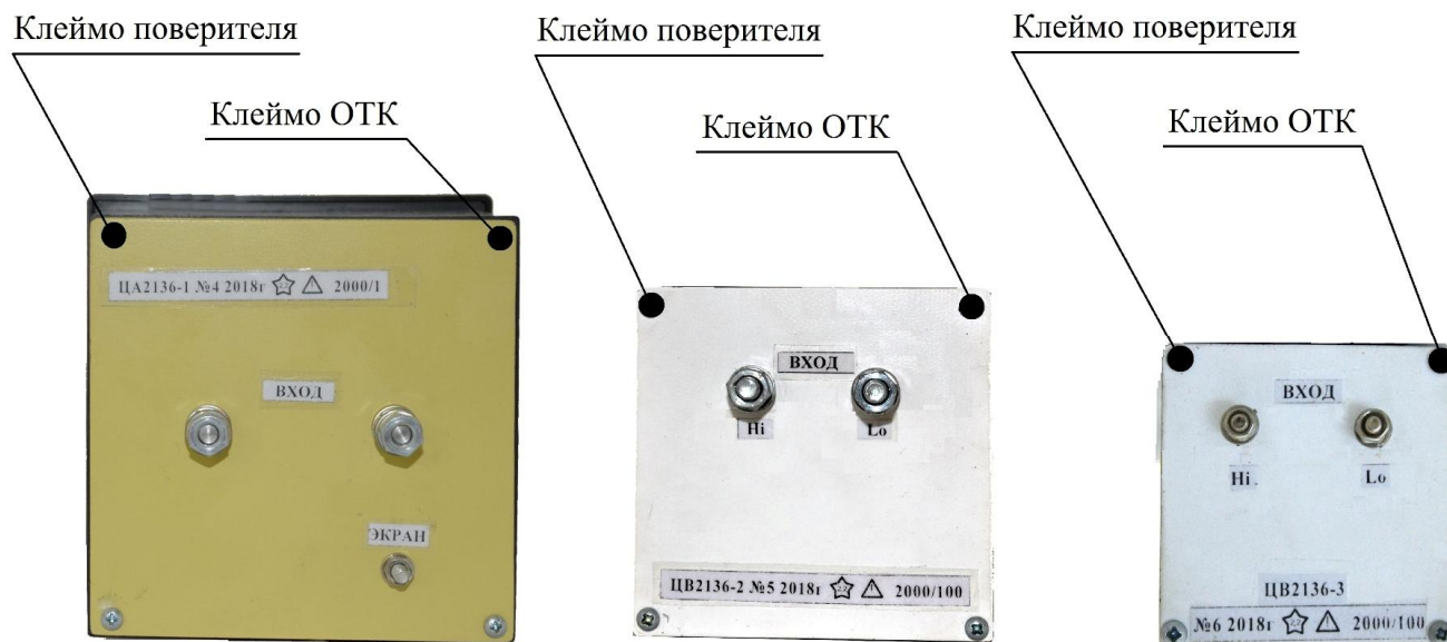
Рисунок 2 – Схемы пломбировки от несанкционированного доступа, обозначение мест нанесения знака поверки
