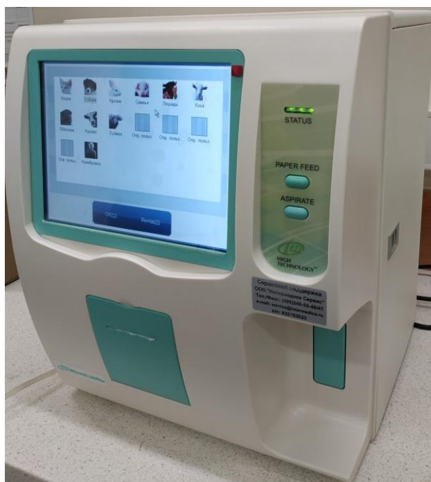
Рисунок 1 – Общий вид анализаторов гематологических MicroCC-20plus (Veterinary)
