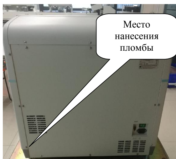
Рисунок 2а – Схема пломбировки от несанкционированного доступа, обозначение места нанесения знака поверки анализатора биохимического автоматического модели BS-230
