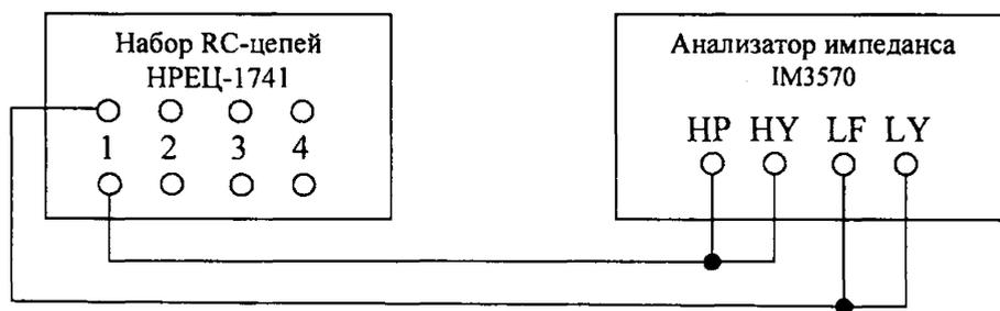
Рисунок 1 – Блок-схема измерения RC цепи анализатором импеданса IM3570
