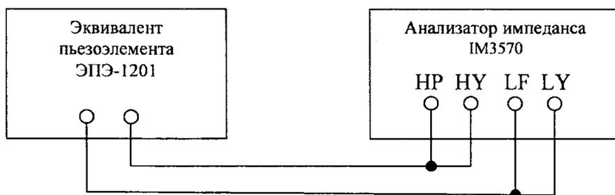
Рисунок 3 – Блок-схема измерения параметров эквивалента пьезоэлемента анализатором импеданса IM3570
