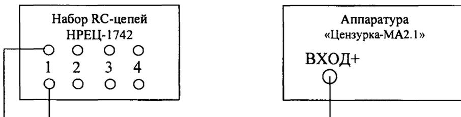
Рисунок 6 – Блок-схема измерения RC цепи аппаратурой «Цензурка-МА2.1»
