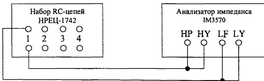
Рисунок 5 – Блок-схема измерения RC цепи анализатором импеданса IM3570
