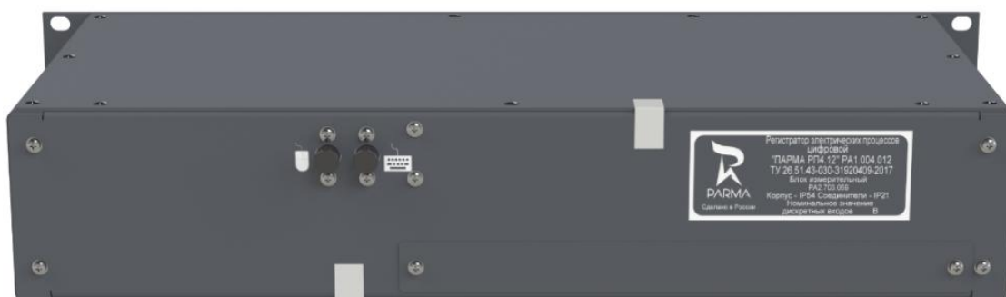
Рисунок 3 – Тыльная панель регистратора в одностороннем исполнении
