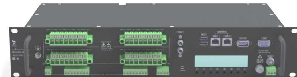
Рисунок 2 – Лицевая панель регистратора в исполнении с двумя оптическими разъемами ST для синхронизации от внешнего сервера точного времени с поддержкой IRIG-B или системы приема и передачи сигналов точного времени «ПАРМА PB9.01»
