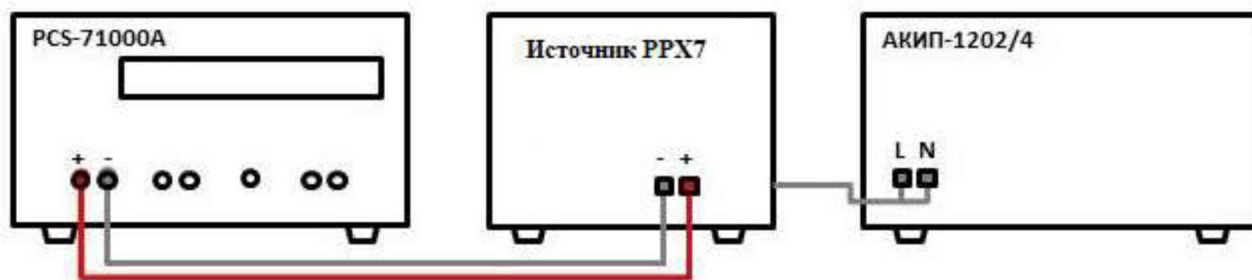
Рисунок 2 – Схема соединения приборов для определения погрешности установки/измерений силы постоянного тока
