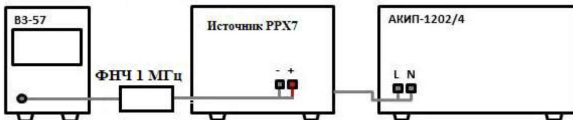
Рисунок 3 – Схема соединения приборов для определения уровня пульсаций выходного напряжения
