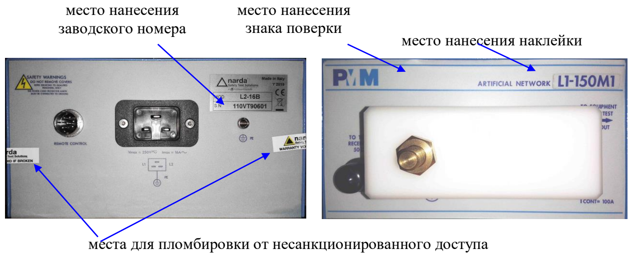
Рисунок 2 - Места для пломбировки, нанесения заводского номера и знака поверки
